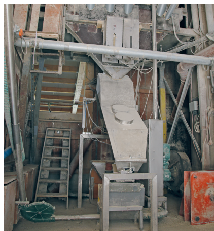
Als Schrägmischer dient eine umgebaute CCM-Anlage.
